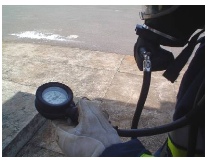
Figura 30 - Verificação da pressão
