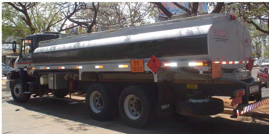
Figura 29 – Tipo de recipiente sujeito a BLEVE
