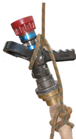
Figura 134 – Amarração na extremidade da mangueira e cote na extremidade do esguicho
