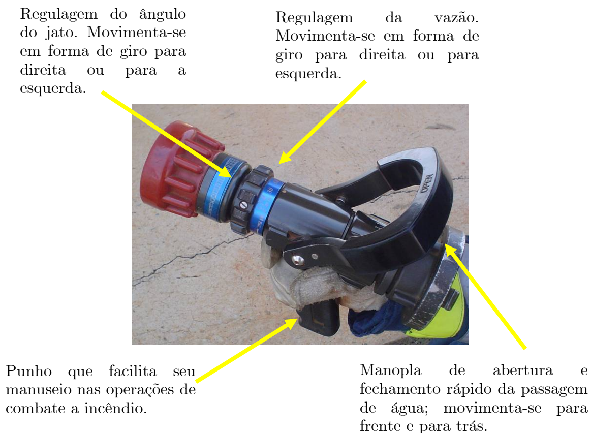
Figura 52 - Partes do esguicho regulável
