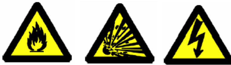
Figura 13 - Placa de alerta: risco de incêndio, de explosão e de choque elétrico, respectivamente
