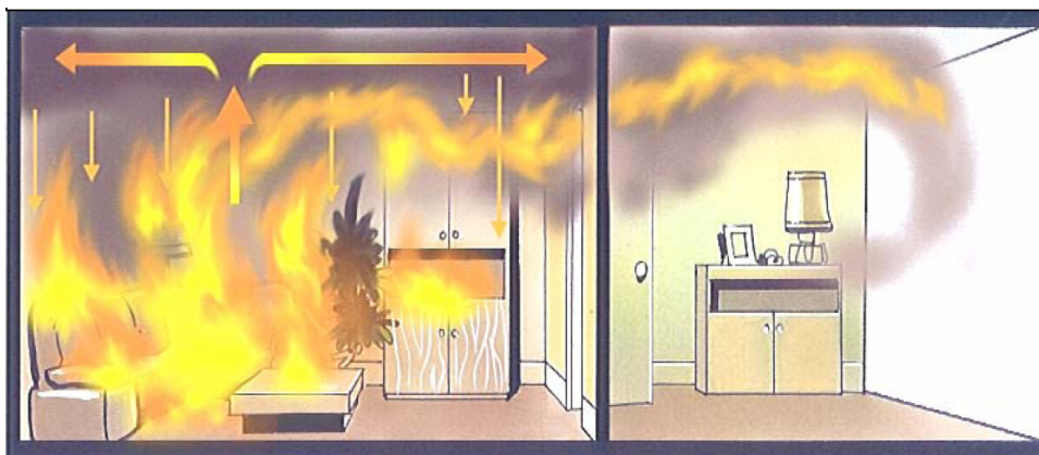
Fonte: Le guide national de référence Explosion de Fumées – Embrasement Généralisé Éclair Figura 70 - Generalização do incêndio ( flashover )
