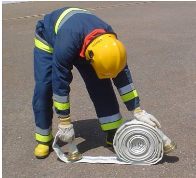
Figura 100 - Posição inicial de desenrolamento da mangueira de 2\frac{1}{2} polegadas
