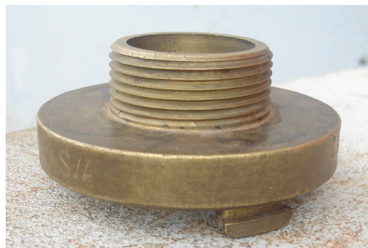
Figura 69 - Adaptador junta storz para rosca macho
