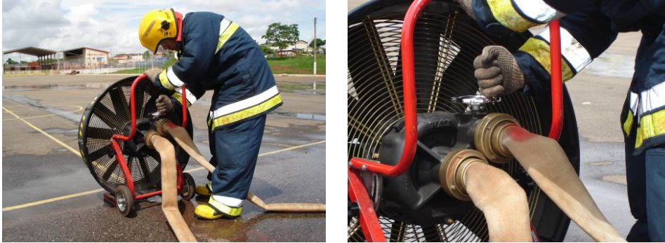
Figura 205 - Abrir o registro para utilizar o ventilador
