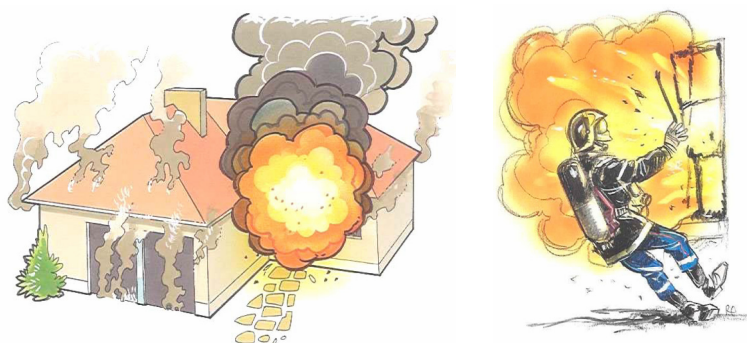
Figura 74 - Situação de explosão da fumaça causada pela abertura incorreta do ambiente
