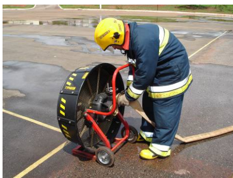
Figura 201 - Conexão da mangueira no ventilador
