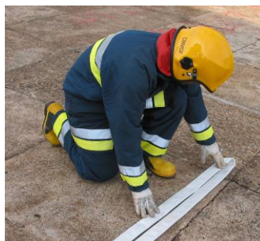
Figura 84 - Posicionamento inicial da mangueira para o aduchamento pelo seio
