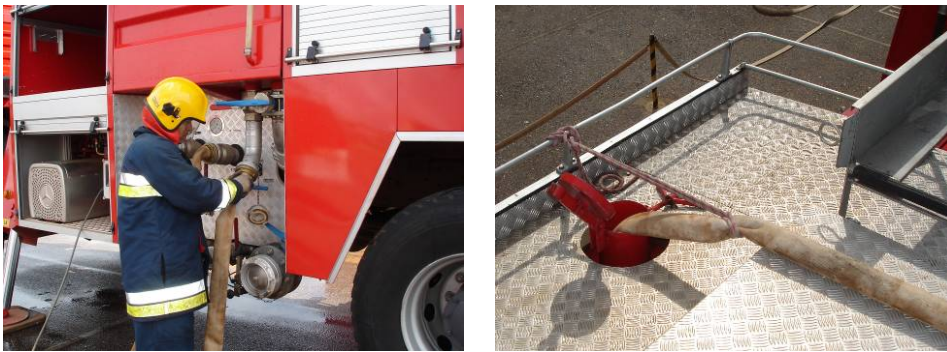
Figura 203 - Conexão da mangueira de retorno da água na viatura
