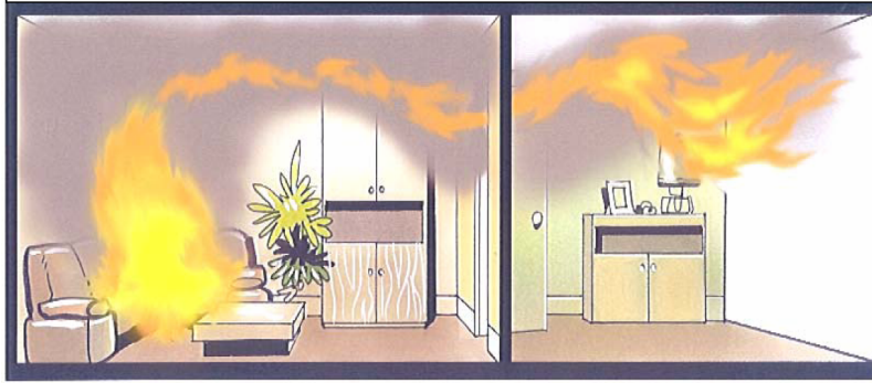
Fonte: Le guide national de référence Explosion de Fumées – Embracement Généralisé Éclair Figura 67 – Línguas de fogo buscando oxigênio no compartimento ao lado
