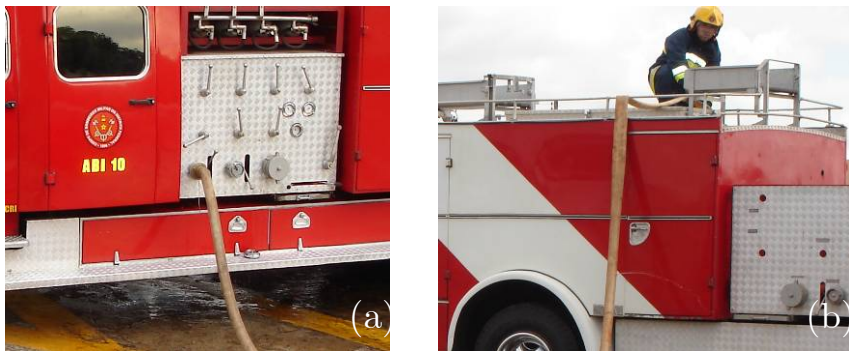
Figura 140 - Abastecimento de hidrante urbano utilizando a mangueira
