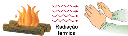
Figura 42 - Transferência de calor por radiação térmica
