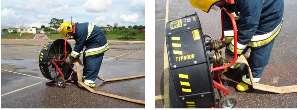
Figura 202 - Conexão da mangueira de retorno da água no ventilador
