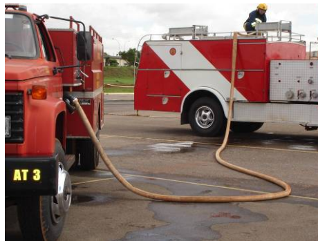
Figura 142 - Abastecimento realizado por outra viatura utilizando mangueira
