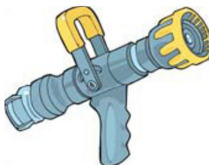
Figura 147 - Esguicho de jato atomizado
