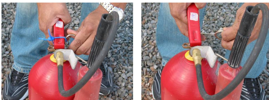
Figura 40 - Rompimento do lacre
