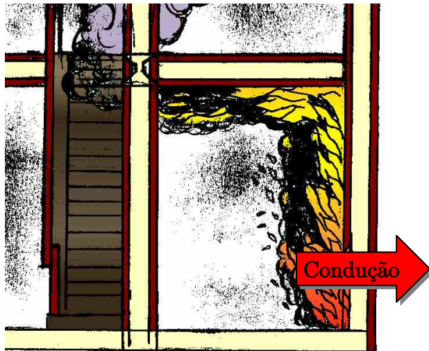
Figura 33 – Transferência de calor por condução através da parede
