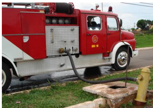
Figura 138 - Abastecimento de hidrante urbano utilizando o mangote
