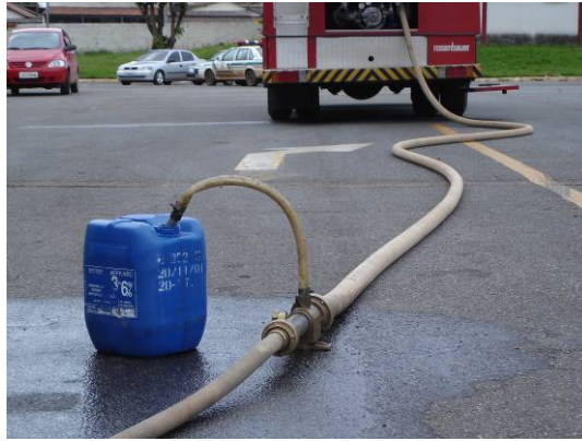
Figura 135 - Misturador entre linhas
