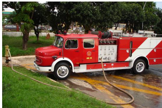
Figura 139 - Abastecimento de hidrante utilizando mangueira
