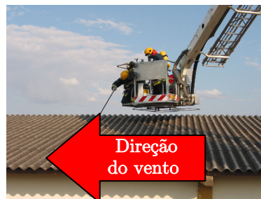
Figura 194 - Ventilação vertical com auxílio da plataforma mecânica
